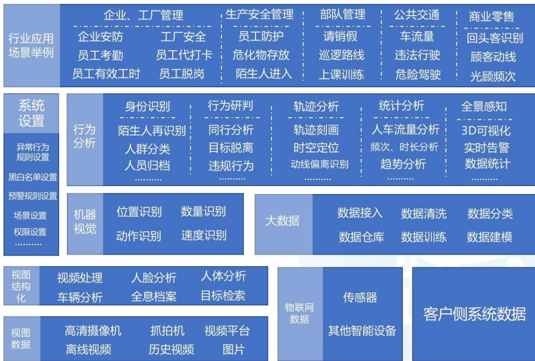
图 1 基于人工智能与机器视觉的视频行为分析系统功能架构
