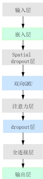
图 2 基于注意力机制的双向 GRU 神经网络模型结构图
